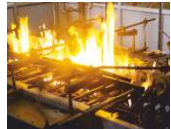
BEAKER MACHINE : 6000 pcs per shift
