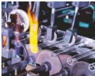
TEST TUBE MACHINE : 40000 pcs per shift
